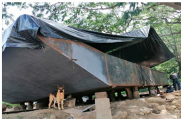
Fotografía 6. Planchón o pontón
