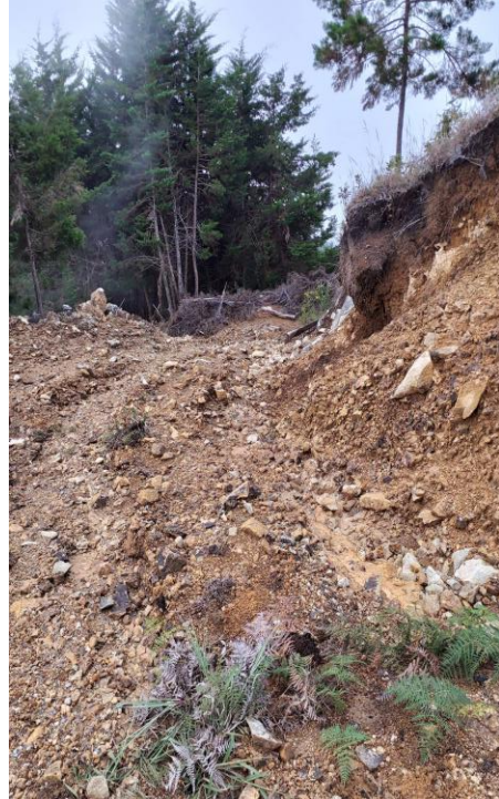
Observaciones: Frente de explotación (inactivo), con procesos erosivos superficiales.
