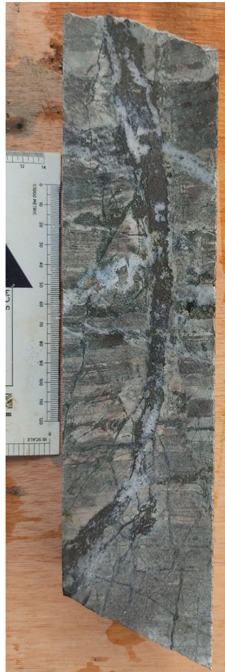
Figura 7. Testigo de perforación mineralizado.
