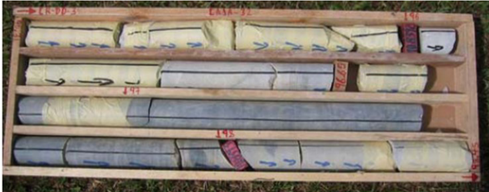
Figura 11. Núcleo orientado preparado para ser muestreado.
