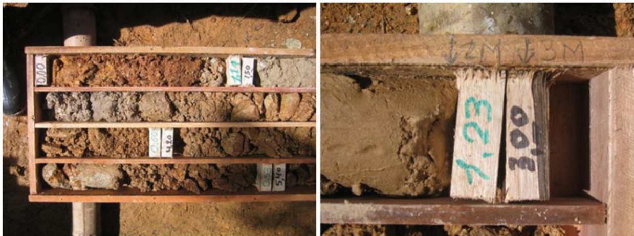
Figura 9. Ejemplo de la medición de la recuperación de la muestra en el núcleo de perforación
