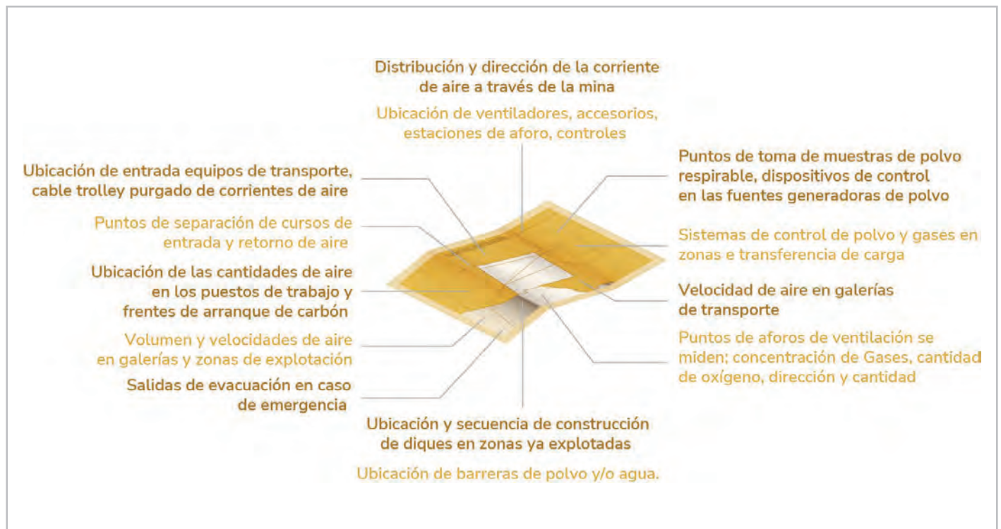
Elementos del circuito de ventilación
